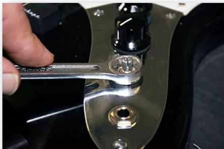
**SUR LA PLAQUE ÉLECTRONIQUE D'ORIGINE**, démontez les 3 potentiomètres ainsi que le jack.
